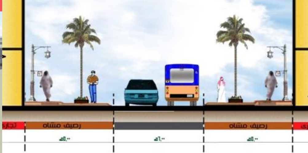
قطاع عرضي بشوارع الصناعة (مقترح)
